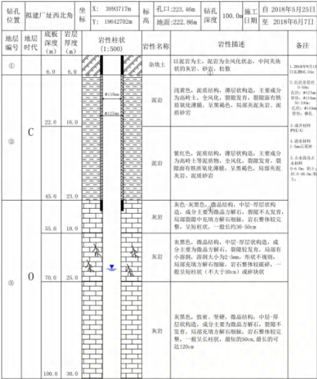
图 6.3-13 豫光金铅玉川厂区地质钻孔柱状图
